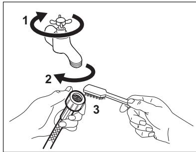
2. Prívodnú hadicu odpojíte od spotrebiča uvoľnením krúžkovej matice.
