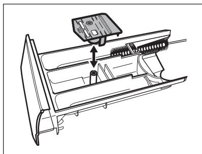
3. Ujistěte se, že jste z horní a dolní části výklenku odstranili veškeré zbytky pracího prostředku. K vyčištění výklenku použijte malý kartáč.
