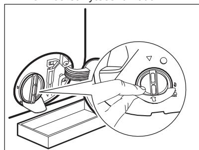
4. Filter otvorte otvorením o 180 stupňov proti smeru hodinových ručičiek, nevyberajte ho. Vypustite vodu.
