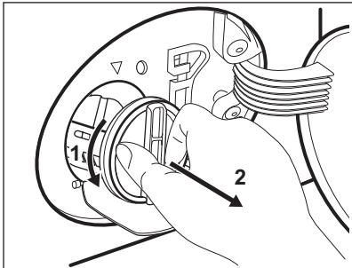
8. V případě potřeby odstraňte vlákna a předměty z výklenku filtru.
