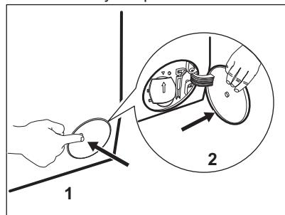
2. Pod vývod vypúšťacieho čerpadla položte vhodnú misku, aby ste zachytili vytekajúcu vodu.
