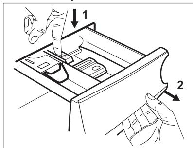
2. Odstraňte horní část komory na přisady, abyste usnadnili čištění, a vypláchněte ji pod tekoucí teplou vodou, abyste odstranili jakékoli stopy nahromaděného pracího prostředku. Po vyčištění vraťte horní část na místo.
