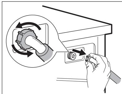
3. Kefkou na zuby vyčistite filter ventilu na zadnej strane spotrebiča.
