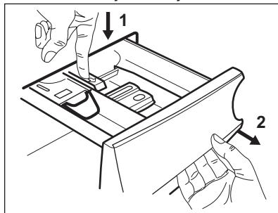
2. Odstráňte vrchnú časť priehradky na aviváže, aby ste si zjednodušili čistenie, a násypku vypláchnite pod tečúcou teplou vodou, aby ste odstránili akékoľvek stopy nahromadeného prostriedku. Po vyčistení vráťte vrchnú časť na svoje miesto.
